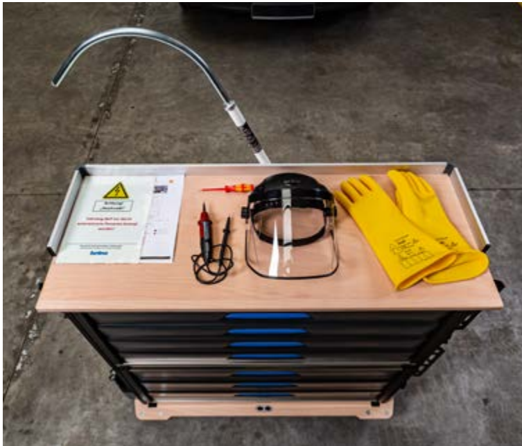
Mobiele werkplek met hoog voltage
